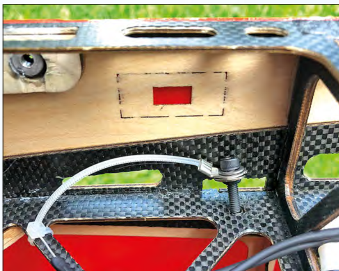
Zajištění pojišťovacího šroubu poloviny křídla proti ztrátě
